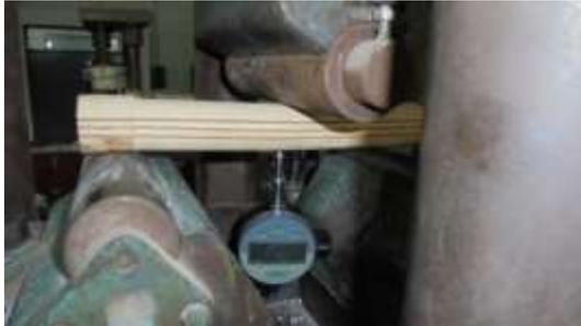
**Fig. (2): Bend test**
