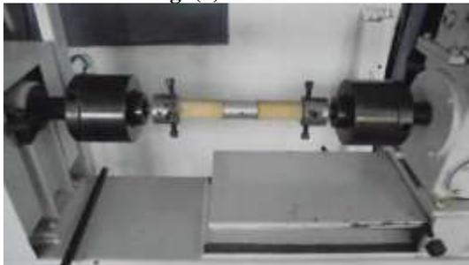
**Fig. (4): Torsion test**
