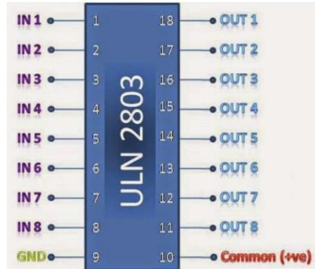
Figure 2.14 IC ULN2803 Pin Diagram
