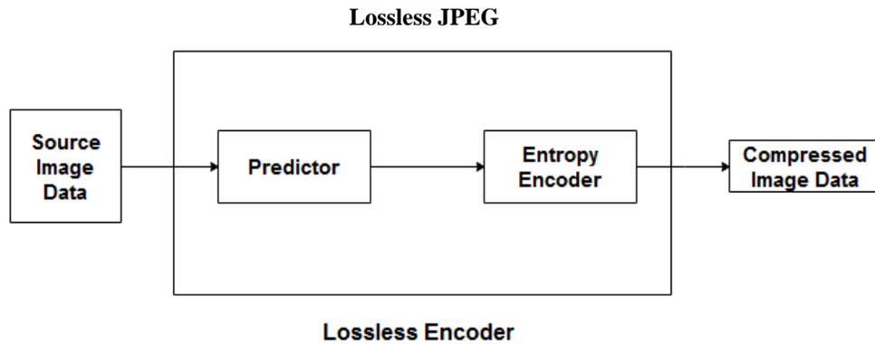
FIGURE 3 : BLOCK DIAGRAM OF LOSSLESS JPEG.
