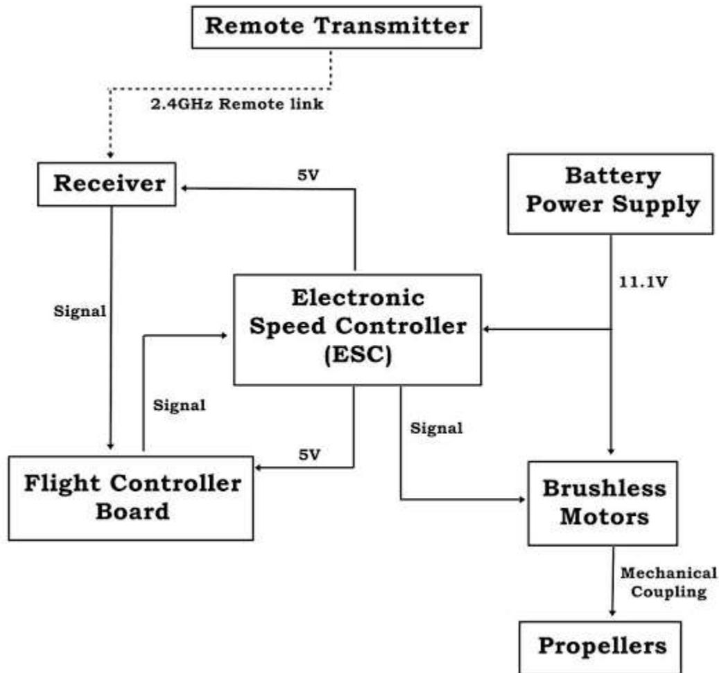
FIGURE 2: DRONE BLOCK DIAGRAM
